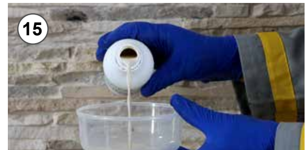
15 - Versare parte di ossido miscelato in un contenitore 15 - Pour the mixed oxide into a little container
